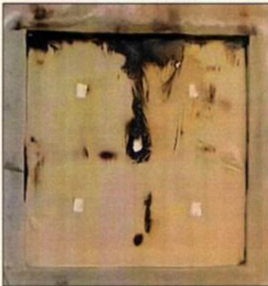
KONDISI PERMUKAAN BELAKANG BENDA UJI (UNEXPOSED SURFACE) SETELAH UJI
